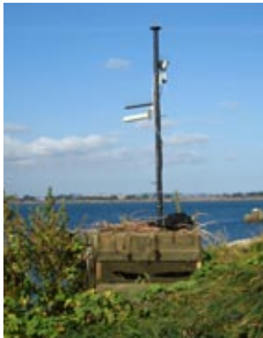
Caméra, système d'émission-réception de l'image et affût de l'île aux Dames. Videocamera, image transmitter/receiver system and hide of the isle aux Dames.
