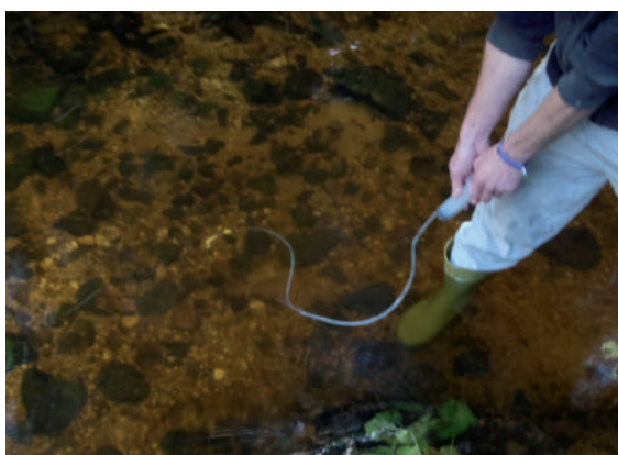
Seringue équipée pour prélever de l'eau interstitielle.
