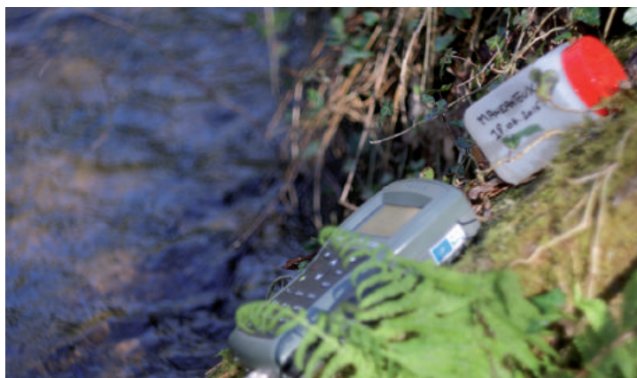
Matériel: multiparamètre, flacon de prélèvement et enregistreur de température HOBO.
