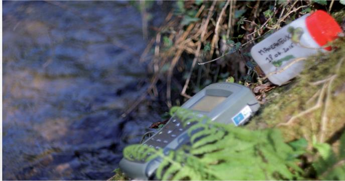
Matériel : multiparamètre, flacon de prélèvement et enregistreur de température HOBO.
